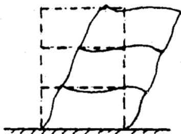
fig. 2.3 Estructura de Cortante
