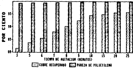
GRAFICA 3. COMPARACION DE COBRE RECUPERADO CONTRA PUREZA DE POLIETILENO CON DIFERENTES TIEMPOS DE AGITACION
