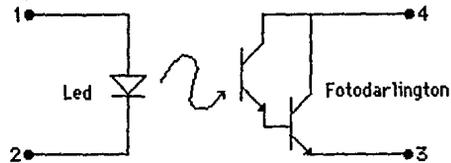
Esquema del optoacoplador.
