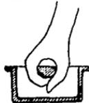
La tapa es circular, con una asa gruesa (20 mms.) y en forma de medio cilindro que, la atraviesa de ludo a ludo, quedando al nivel de la propia tapa y, en ella se colocan los dedos cómoda y seguramente para levantarlo. La tapa es suficientemente honda (30 mms.) para la entrada de los dedos cuando se toma.
