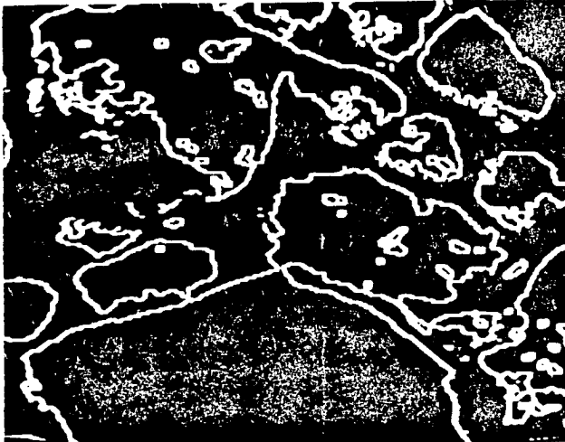
Figura 16. Obtención de contornos aplicando el laplaciano a la imagen de la figura 15.
