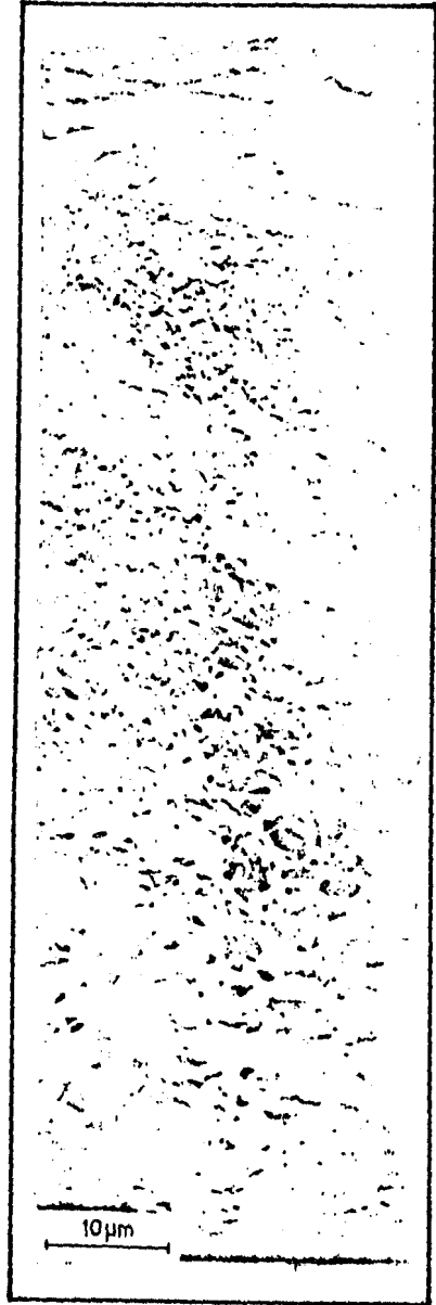
Figura 2.10 Sección transversal de una membrana compuesta fabricada por UOP, modelo PA-300.
