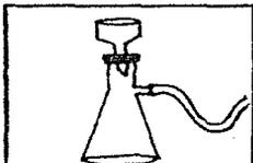
o bien, cuando es posible, filtrando al vacío, es decir con la ayuda de un matraz especial llamado kitazato, que se conecta a una bomba de vacío, con la que se logra succionar el aire y --
