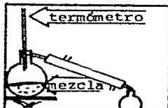
Al calentar la mezcla que se encuentra en el matraz, se alcanza su punto de ebullición el cual se mide mediante el termómetro integrado al equipo.
