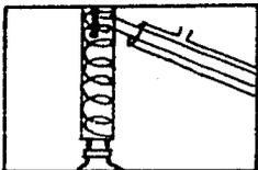
de esta forma se logra que el líquido menos volátil se condense al entrar en contacto con las paredes frías de la columna y regrese al matraz, en tanto que el líquido mas volátil resulta completamente destilado.
