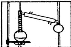
lo que hay que hacer entonces es conectar al aparato de destilación una columna de fraccionamiento cuyo objetivo es alargar lo mas posible el trayecto que recorren los vapores,
