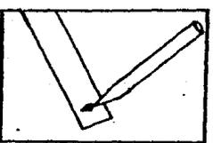
En uno de los extremos de una tira de papel que representa la fase estacionaria, se aplica una muestra de la mezcla, por ejemplo de tinta negra y se introduce en un tubo que contenga una cantidad de disolvente
