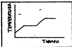
Observen esta gráfica de calentamiento de una destilación fraccionada. El número de componentes en la mezcla está indicado por el número de veces que la temperatura permanece constante.
