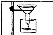
La filtración consiste en hacer pasar la mezcla a través de un medio poroso llamado filtro.
