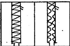
Mientras menor sea la diferencia de los puntos de ebullición de los componentes, mayor deberá ser la altura de la columna.
