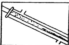
en ese momento la sustancia se evapora, sube y pasa por un tubo refrigerante donde vuelve al estado líquido, es decir, se condensa debido al contacto con las paredes frías del refrigerante
