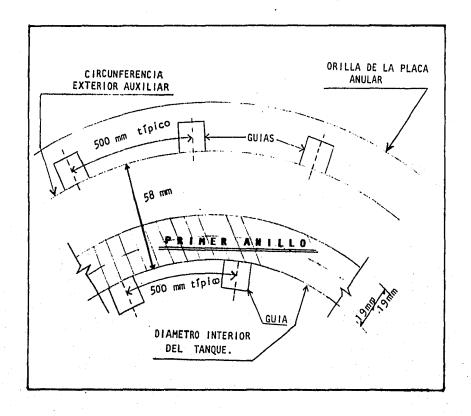
DIBUJO IV.2. Colocación típica de apoyos para acomodar las placas del primer anillo -del tanque de almacenamiento.
