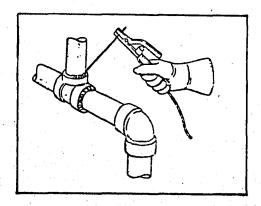
Fig. I.9 . Unión de accesorios de juntas soldables.
