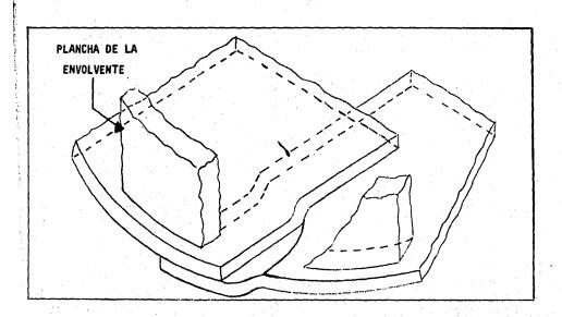
Dibujo III.7 . AJUSTE DE LAS PLACAS DE FONDO DEL TANQUE.
