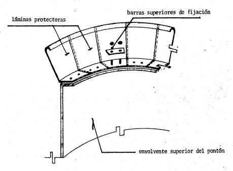
Dibujo V.6. Barras superiores de fijación de banda y láminas de -protección contra la lluvia.
