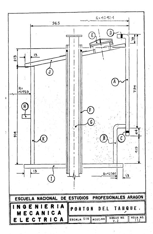
También se puntea y se suelda progresivamente a la envolvente interior, un anillo (H) de espesor y ancho de 1 por 7.6 cm (3/8 por 3 pulg.), conformado con placas de largo opcional, que servirá para la fijación posterior del diafragma.
