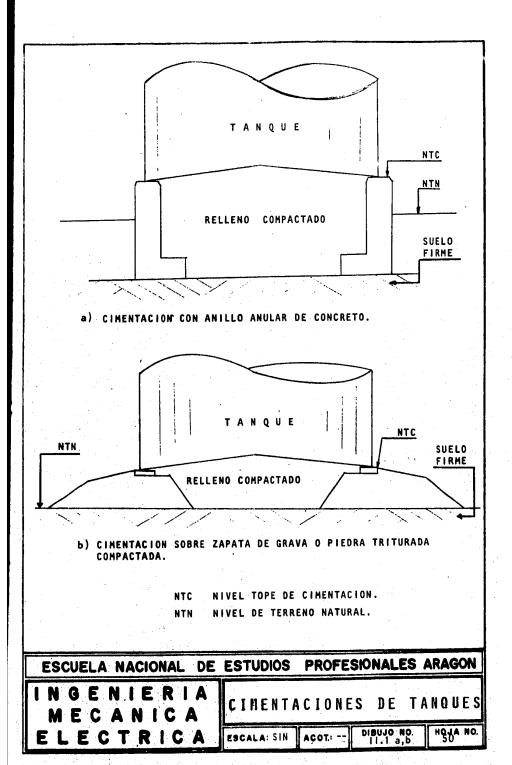
Tiene además, este tipo de cimentación con muro anular, las si--guientes ventajas sobre la de terracerías sin anillo:
