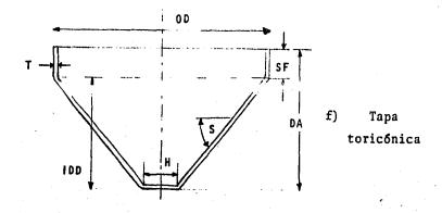
00 Diametro exterior del tanque.
