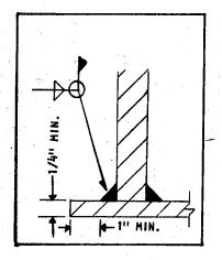
Dibujo III.8. JUNTA DE LA ENVOLVENTE CON EL FONDO DEL TANQUE.
