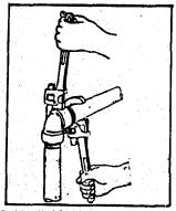
Fig. I.10. Unión de accesorios roscados.
