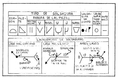
DIBUJO III.2 . SIMBOLOGIA EMPLEADA PARA REPRESENTAR TIPOS Y \_\_\_\_\_OTRAS ESPECIFICACIONES DE LA SOLDADURA (APROBADA POR LA A.W.S.).
