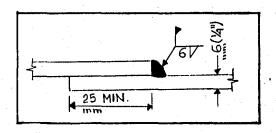
Dibujo III.9 . JUNTA DE LAS PLANCHAS DEL FONDO DEL TANQUE.
