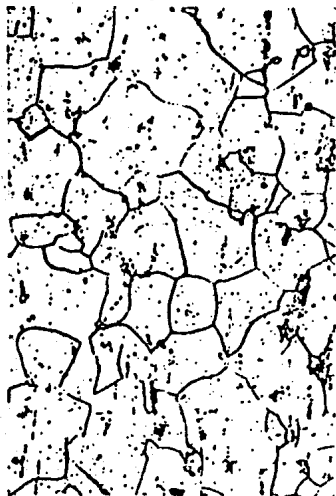
-Estructura de recocido del acero CK 10 durante un tiempo demasiado largo (250 aumentos). Fig.17
