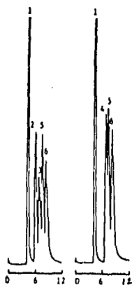
Fig. 26.- Separación de una mezcla de acetilacetonatos. Picos: 1) Be(II), 2) Ru(III), - - 3) Rh(III), 4) Cr(III), 5) Al(III) y 6) Co(III).
