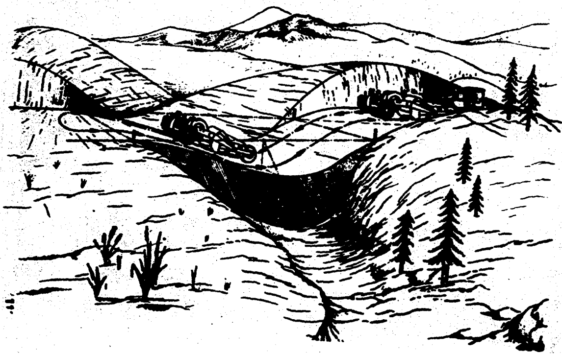
FIG. 1.9 OBRAS DE CORTE Y LLENADO
