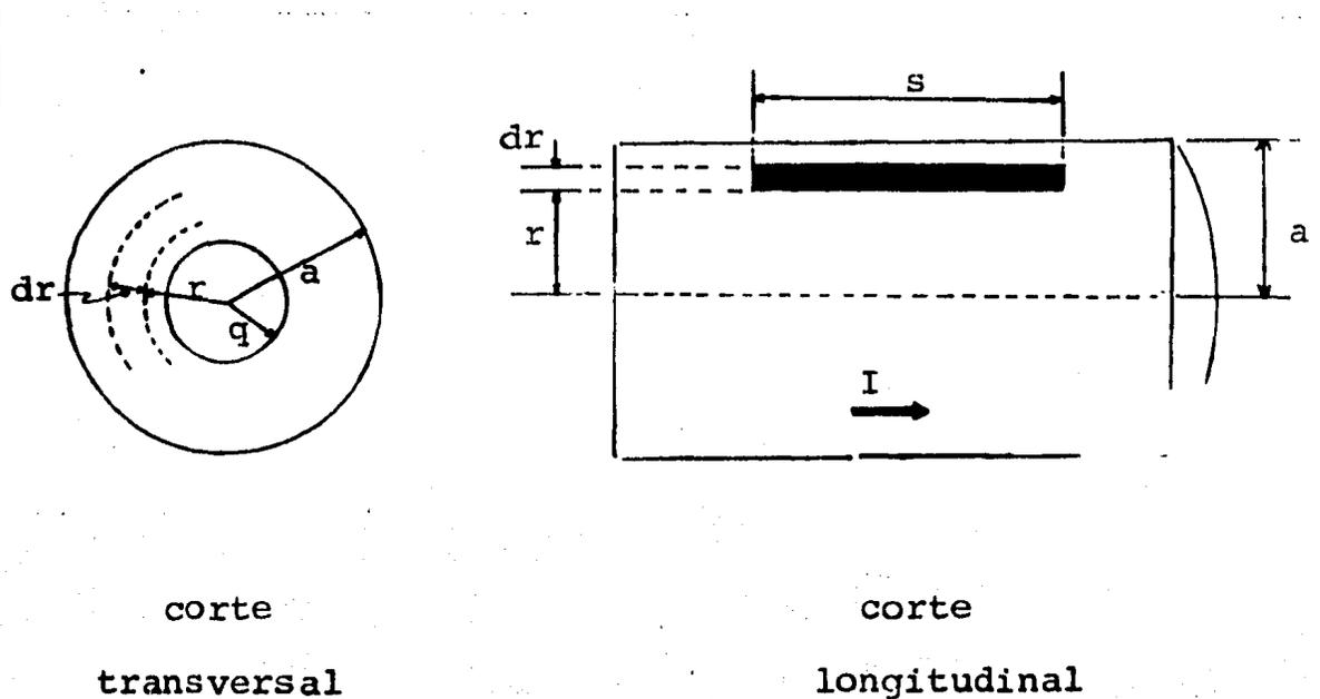
Fig.2.8 Cortes de un conductor cilíndrico recto.
