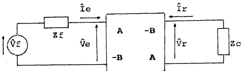
Fig. 4.3 Sistema de transmisión homogéneo
