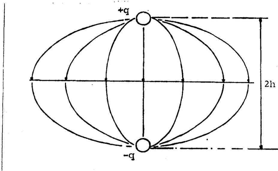
Fig. 2.14 Sustitución del plano de tierra por un conductor ficticio.
