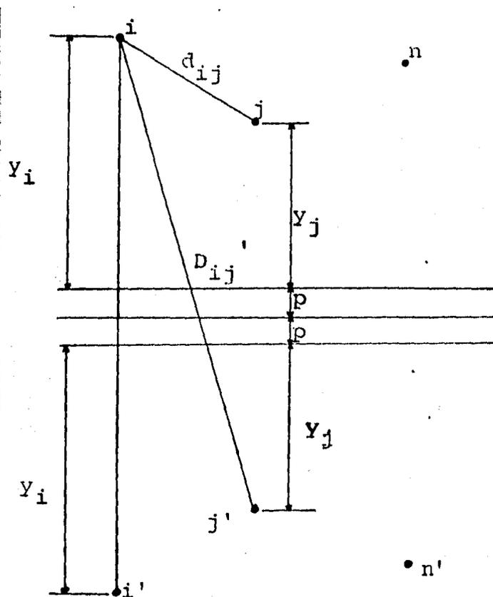
Fig. 2.7 Sistema de conductores reales e imágenes y la profundidad compleja de penetración.
