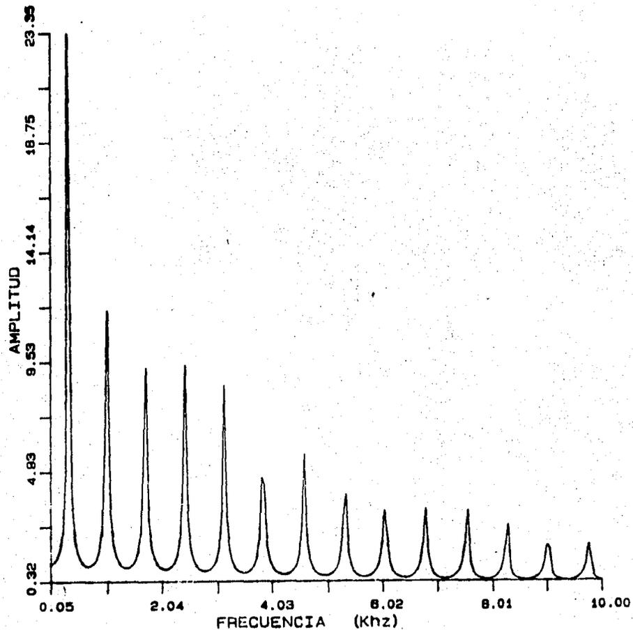
Fig. 5.10 Respuesta en frecuencia típica de una línea de transmisión.
