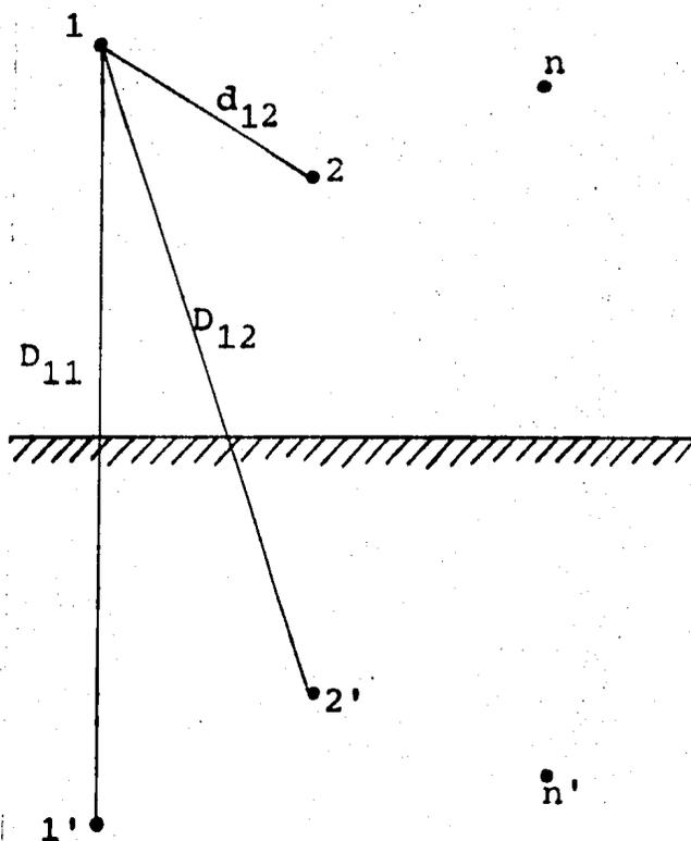
Fig. 2.5 Sistema de conductores reales y sus imágenes.
