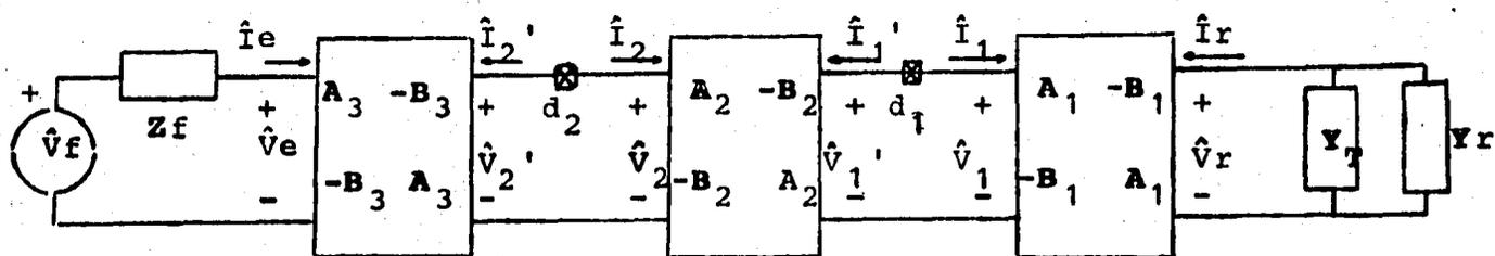
Fig. 4.5 Sistema de transmisión no Homogeneo
