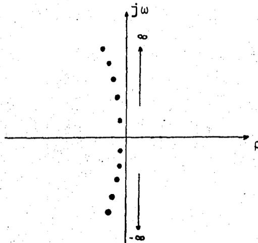
Fig. 5.9 Diagrama de polos típico de una línea de transmisión
