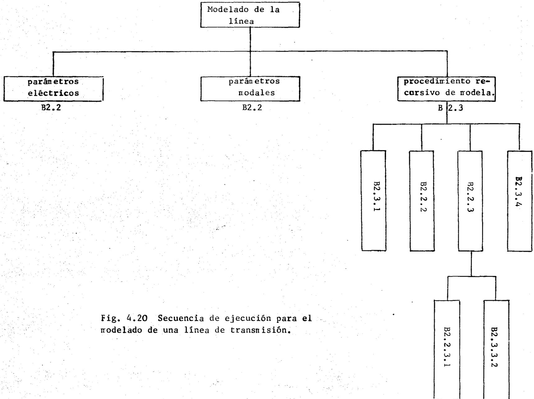
Fig. 4.20 Secuencia de ejecución para el modelado de una línea de transmisión.
