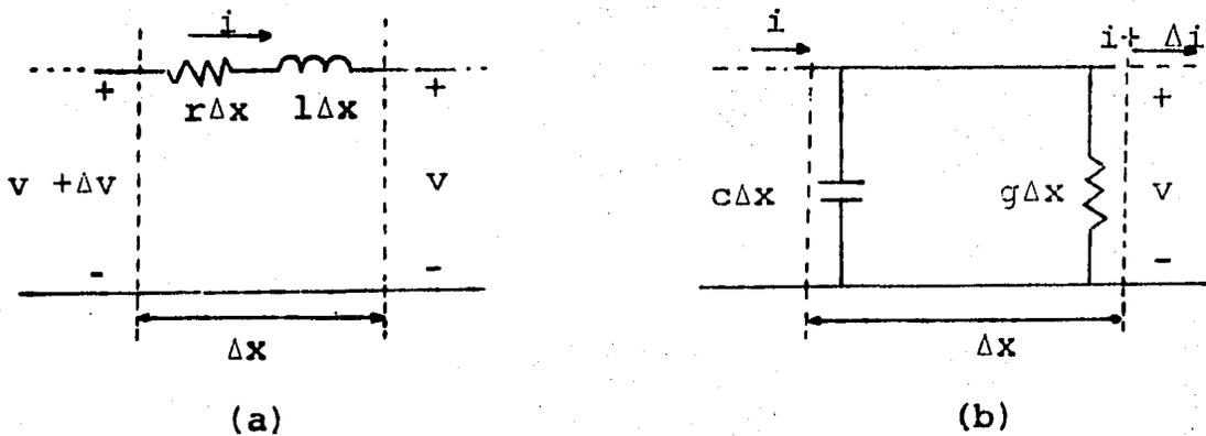
fig.1.1 Sección elemental de una línea de transmisión.
