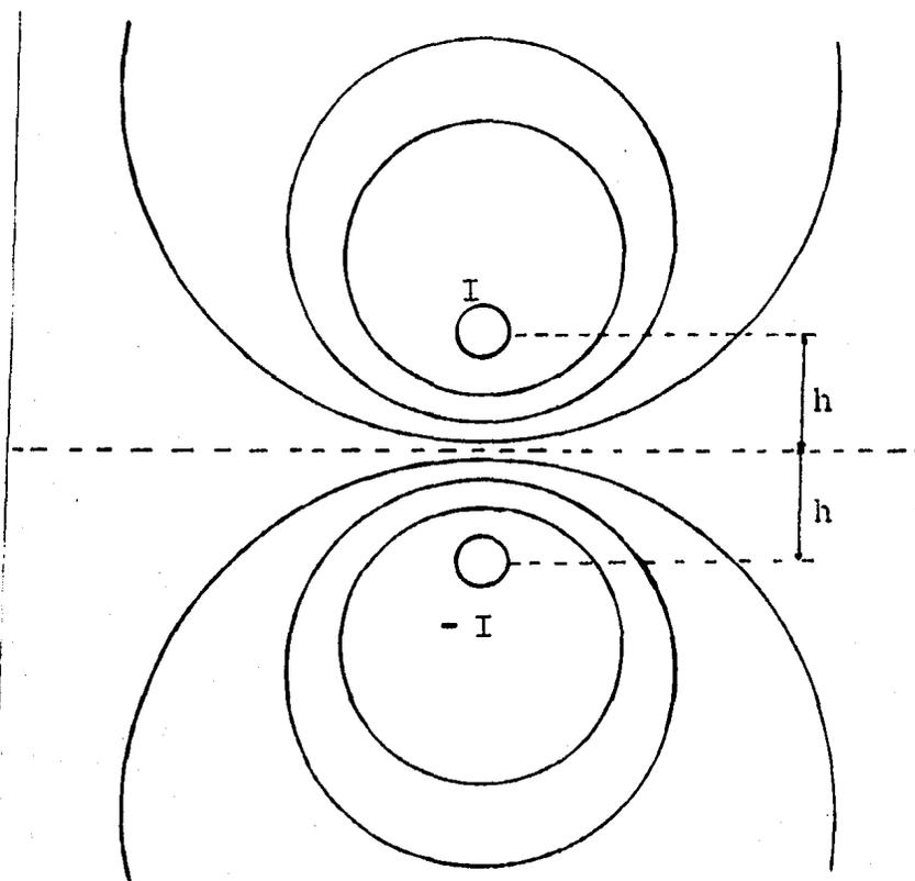
Fig.2.4 Sustitución del plano de tierra por un conductor ficticio
