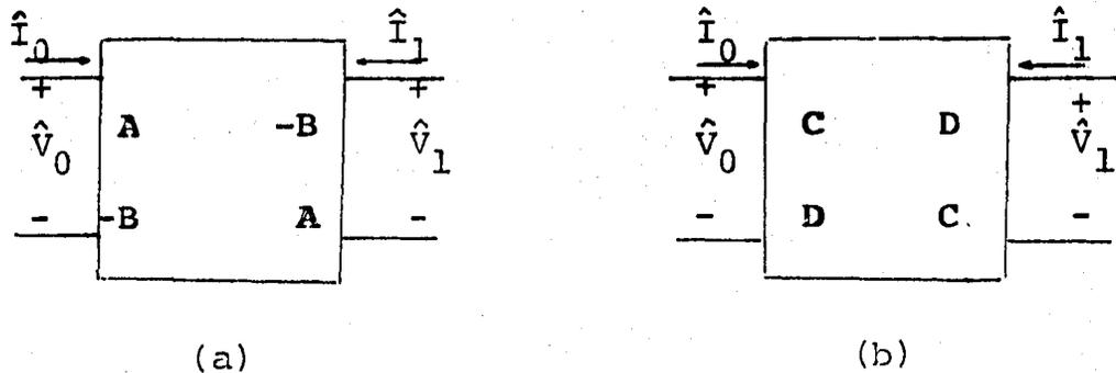
Fig. 4.2 Modelos de dos puertos de una línea de transmisión homogénea.
