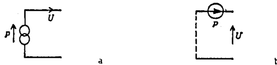
Figura 23.- Símbolos para el generador de presión constante en las analogías de tipo impedancia (a) y de tipo movilidad (b).
