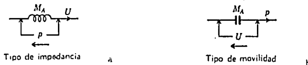
Figura 17.- Símbolos para la masa acústica, según la analogía tipo impedancia (a), y movilidad (b).
