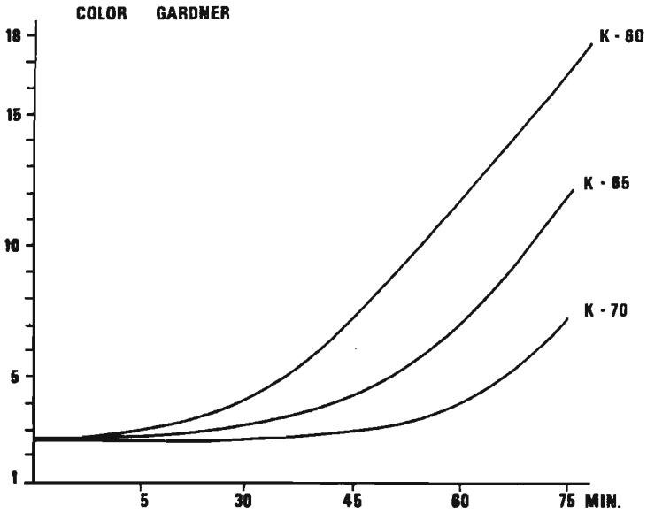
Fig. 3-6 Correlación entre el valor de K y la estabilidad del PVC ( a 180°C ) medido del color en Color - Gardner.
