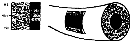
FIG.7 Composición de la fibra hueca
