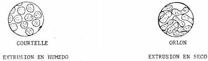
Figura 2.1 SECCION TRANSVERSAL DE FIBRAS ACRILICAS.
