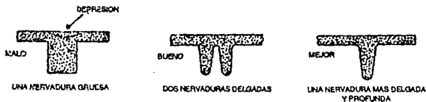
Fig. 6.15. Diseños alternativos de nervaduras para mantener uniformidad de espesor. (Ref. 2).
