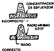
Fig. 6.13. Radios en nervaduras y protuberancias de una pieza. (Ref. 2).
