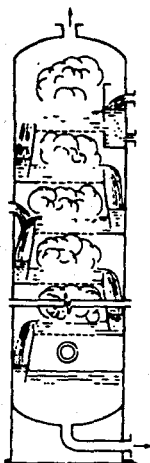
FIGURA 5.2.4.3. LAVADOR (TORRE) DE PLATOS
