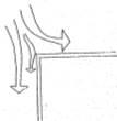
Evitar ubicación de servicios al Noreste para que el viento no lleve malos olores al resto del conjunto
