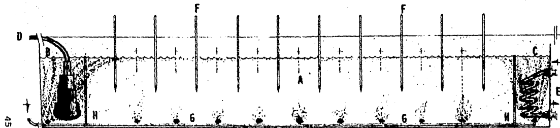
FIGURA 1.- ESQUEMA DEL GRADIENTE HORIZONTAL DE TEMPERATURA UTILIZADO. A SEGMENTOS DEL GRADIENTE, B CAMARA CALIENTE, C CAMARA FRIA, D RESISTENCIA, E SERPENTIN, F TERMOMETROS, G SISTEMA DE AIREACION Y H MALLA.
