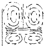
Flujo radial con agitadores de turbina de cuchillas planas.
