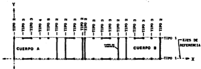
Figura 28 Identificación de marcos tipo para el análisis matemático para el programa SUPER-ETABS en el edificio C
