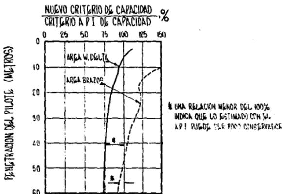
Fig. 3.13. COMPARACION DE CAPACIDADES CON EL NUEVO CRITERIO Y EL CRITERIO A. P. I.
