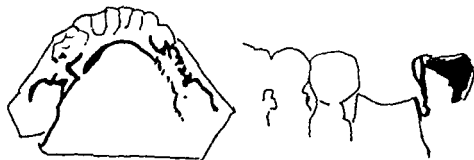
Fig. 5-7 Prótesis parcial inferior con apoyos oclusales internos. A, apoyos internos en 4 coronas pilares; B, vista oclusal mostran - do los planos de guía proximales; C, vista bucal mostrando los desgastes paralelizadores de las caras proximales; D, colado con aleación de oro terminado, con reten - ción lingual en alambre forjado sobre los 4 pilares. El uso del brazo vestibular estabilizador es operativo.
