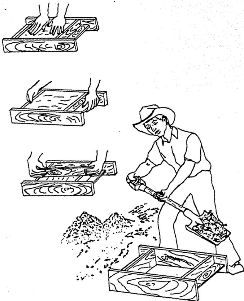
FIG. 1 Proceso de fabricación de bloques de adobe.
