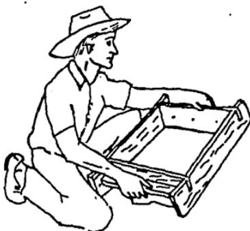
FIG. 26 Se muestra el molde típico de madera para la elaboración de adobes macizos.
