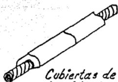
Cubiertas de concreto para protección de cables subterráneos.-
