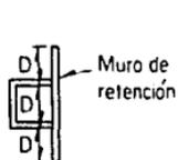
c) Tubo de elevación con muro de retención para evitar el vórtice
