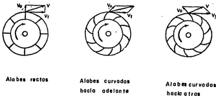
FIG. B-4 TIPOS DE ALABES DE VENTILADOR.
