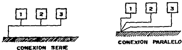
Fig. 5.1.- Sistemas de conexión de un punto.
