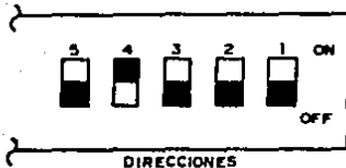
Fig. 2.8.- Interruptores de Instrumento 8.
