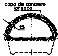
COLOCACION DE LA CAPA DE CONCRETO LANZADO
