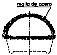
INSTALACION 1a. MALLA
