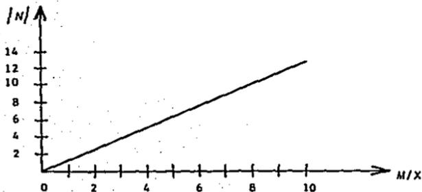
Fig.(1.J). Función descriptiva para la alinealidad conexión-desconexión o sí-no.
