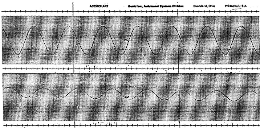
Fig.(2.Q). Respuesta del Regulador INTEGRADOR, a una entrada senoidal.
