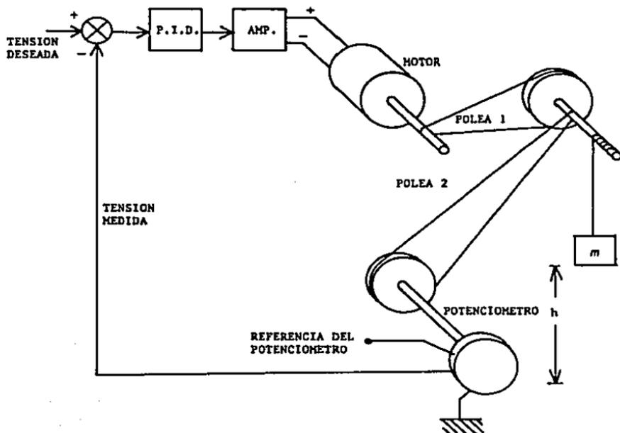
Fig.(4.2). Diagrama esquemático de un sistema regulador de posición.
