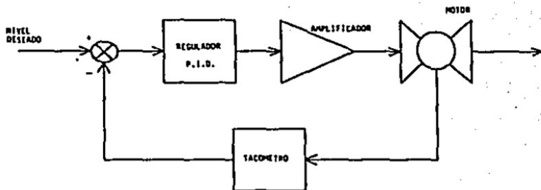
Fig. (3.A). Sistema de control de velocidad angular.
