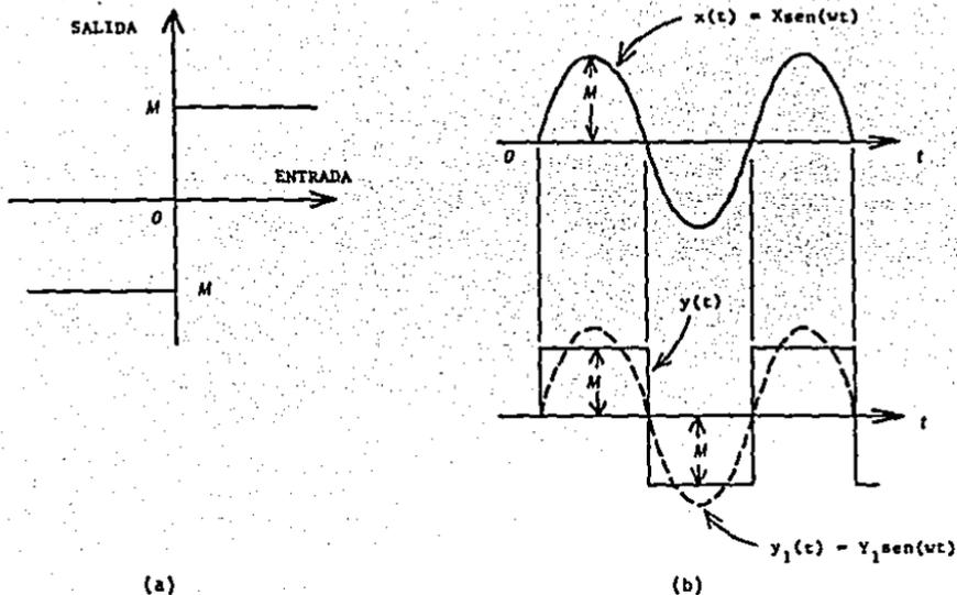
Fig.(1.1). (a) Curva característica de entrada-salida de la alinealidad conexión-desconexión; (b) Formas de onda de entrada y salida de esa alinealidad
