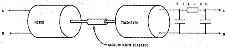
Fig.(3.C). Representación del sistema Motor-Tacómetro-Filtro.
