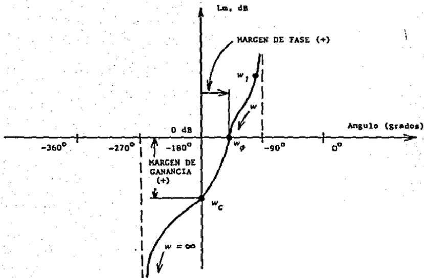
Fig.(1.M). Diagrama de magnitud logarítmica-ángulo obtenido a partir de las curvas de magnitud logarítmica-frecuencia y de ángulo de fase-frecuencia del sistema cuya función de transferencia está definida por la ecuación (1.13).
