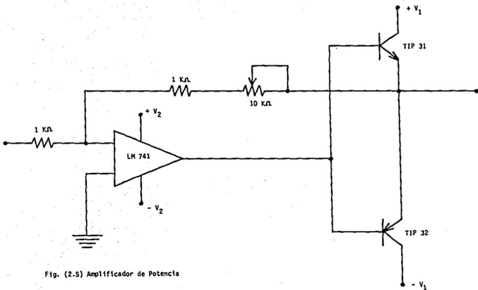
Fig. (2.S) Amplificador de Potencia
