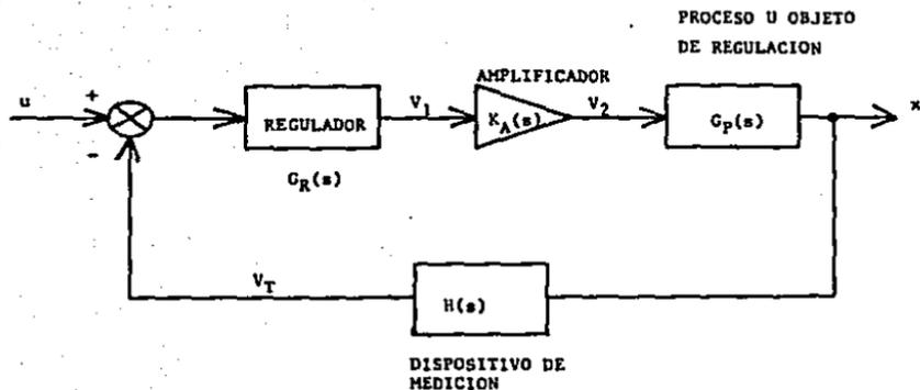
Fig.(2.A.i) Diagrama de lazo cerrado de un sistema de control
