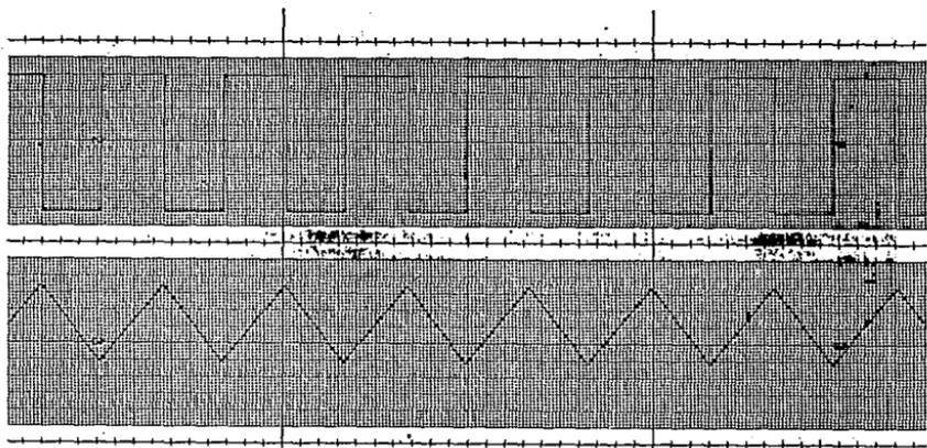
Fig.(2.E). Respuesta del Regulador INTEGRADOR, a una excitación de escalón.
