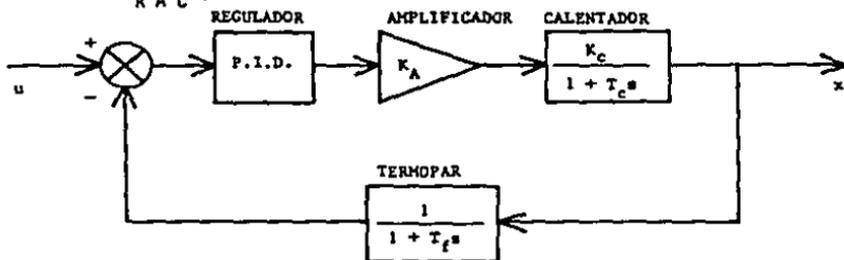
Fig.(4.1). Diagrama de bloques de un sistema regulador de temperatura.
