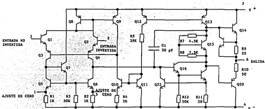
Fig. (A.A). Diagrama esquemático del Amplificador Operacional LM741 .
