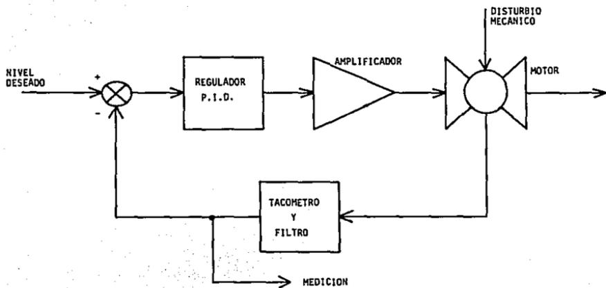
Fig. (3.6). Aplicación de un disturbio al sistema cerrado
