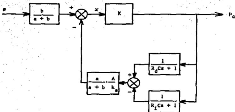
Fig.(4.4) Diagrama de bloques de un regulador PID neumático.
