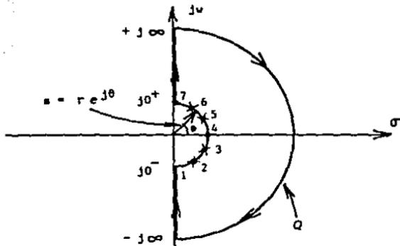
Fig.(1.N). El contorno  $Q$  que encierra la mitad derecha del plano  $s$ .
