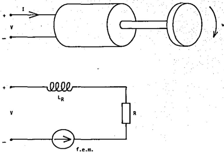
Fig.(3.8). Diagrama representativo y circuito equivalente del motor.
