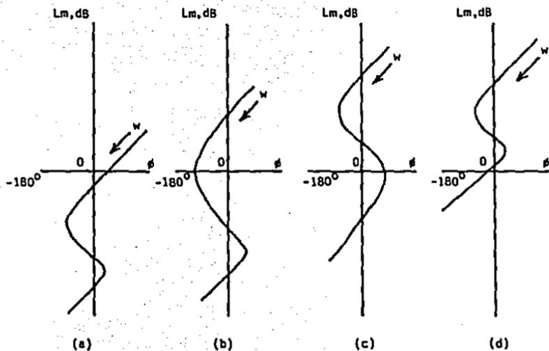
Fig.(1.P). Diagramas de magnitud logarítmica para un sistema condicionalmente estable: (a),(c) estable; (b),(d) inestable.
