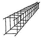
Generalmente el acero de refuerzo que se emplea en la construcción tiene un esfuerzo de fluencia(Fy)de 4200kg/cm2 aunque depende de las características que se quieran para el elemento.
