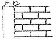
Los muros de tabique no tienen la suficiente rigidez por si solos. Por eso es necesario reforzarlos con castillos y dalas de concreto. Estos elementos son como una especie de columnas y trabes de concreto mas pequeñas; son comunes en dimensiones de 15 x 20 cms. y están armadas con varilla de 5/16" o 3/8" y alambrón. Los castillos y dalas actuan como marcos para cada muro.
