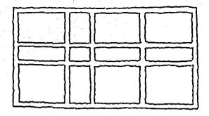
Ya con la excavación terminada pedemos proceder a colocar la mampostería en la cimentación. La cimentación de mampostería es simplemente piedra braza unida con mortero. Se forman cadenas que a su vez forman un bastidor o marco que soportará la losa y el peso de la casa completa. La piedra braza debe de estar apoyada bien nivelada y compactada razonablemente. Si es posible se debe de colocar una plantilla de concreto pobre.
