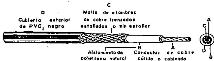
Fig. 27 Cables coaxiales
