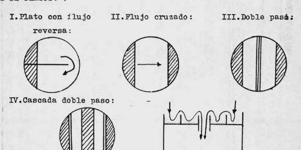
En el diseño de terres de platos perforados es muy importante el cálculo de las perforaciones.
