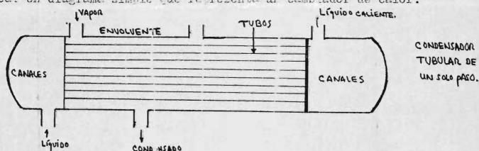
BALANCES DE ENERGIA: Pre una corriente caliente o fría a través de un cambiador de calor:
