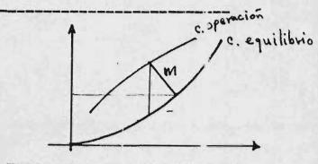
En el caso de que el proceso se adiabático debe realizarse un balance de energía (para la corriente de G que entra y parala que sale), en función de los calores diferenciales de solución, calores latentes y calores sensibles.
