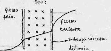
El coeficiente de transferencia de calor, individual o de superficie está dado por:
