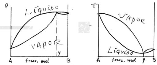
El residuo de la destilación es siempre el azeótropo y, que es una - mezcla de ebullición invariable.
