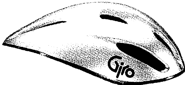
Concha externa delgada, termoformada en (PET), evita la penetración de objetos afilados y mantiene unida la concha interna durante un impacto.
