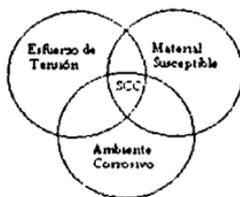
**Figura 1.6** Los tres factores necesarios para producir el agrietamiento por corrosión bajo esfuerzos (SCC).
