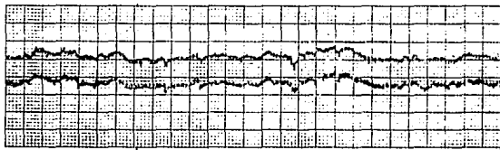
FIGURA I.2.1 g) Traza debida a cable de derivación roto.
