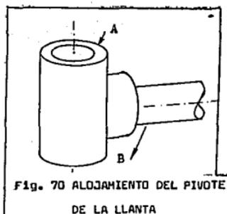
Fig. 70 ALDAMIAMIENTO DEL PIVOTE DE LA LLANTA
