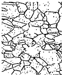
Fig 12.- Aspecto metalográfico de un hierro inoxidable austenítico luego de un tratamiento de solubilización.
