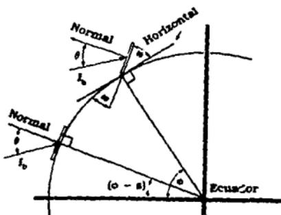
FIG. 3.15 INCIDENCIA DE RADIACION DIRECTA EN UNA SUPERFICIE HORIZONTAL Y EN UNA INCLINADA.  $I_b$  REPRESENTA LA INCIDENCIA DE LA RADIACION SOLAR.
