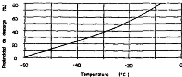
FIG. 4.24 PUNTO DE CONGELACION DE UNA BATERIA PLOMO-ACIDO EN FUNCION DE LA PROFUNDIDAD DE DESCARGA.
