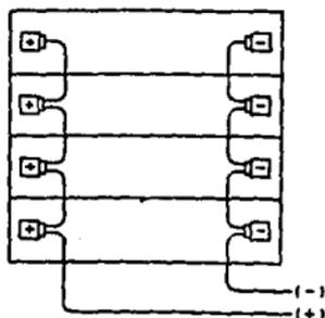
FIG. 4.19 CONEXION DE 4 PANELES EN PARALELO
