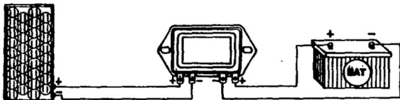
FIG. 4.25 CROQUIS DEL CONEXIONADO DE UN PEQUEÑO REGULADOR SHUNT. AL EFECTUAR EL MONTAJE HA DE COLECTARSE PRIMERO EL CIRCUITO DE LA BATERIA Y DESPUES EL DE PANELES, A FIN DE EVITAR EL PASO MOMENTANEO DE TODA LA INTENSIDAD POR EL CIRCUITO DE DISIPACION.
