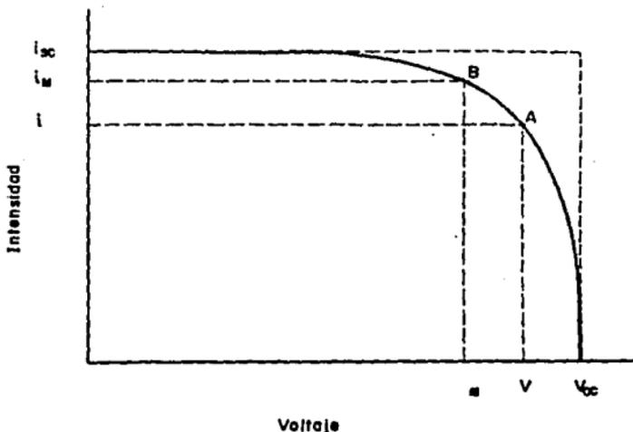
FIG. 4.17 CURVA  $i$ - $V$  DE UN PANEL FOTOVOLTAICO
