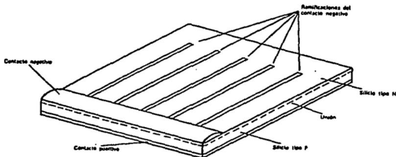
FIG. 4.4. ESQUEMA AMPLIADO DE UNA CELULA SOLAR DE SILICIO.
