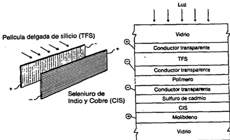
FIG. 4.15 COMBINACION DE DISPOSITIVOS DE DIFERENTE RESPUESTA ESPECTRAL. ESQUEMA DEL CONOCIDO COMO <<TANDEM TFS/CIS>>
