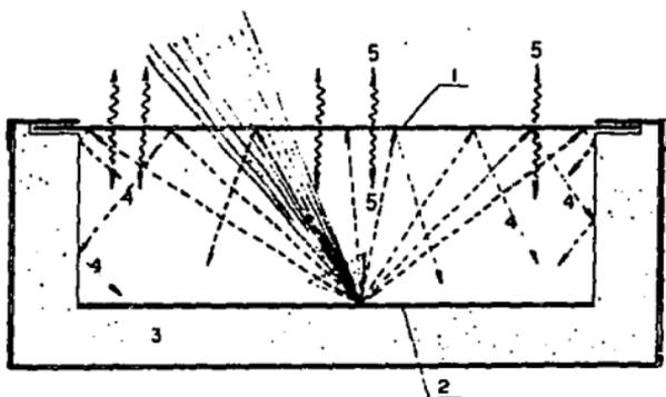
FIG. 4.1 ILUSTRACION DEL EFECTO INVERNADERO EN UN CORTE TRANSVERSAL DE UN COLECTOR TEORICO. PARA UNA MAYOR CLARIDAD LA ESCALA ESTA DISTORSIONADA Y NO CORRESPONDERIA A LA FIGURA DE UN COLECTOR REAL. 1 CUBIERTA TRANSPARENTE. 2 PLACA ABSORBEDORA. 3 AISLAMIENTO. 4 RADIACION REFLEJADA EN EL INTERIOR DEL COLECTOR. 5 RADIACION EMITIDA POR LA CUBIERTA AL CALENTARSE.
