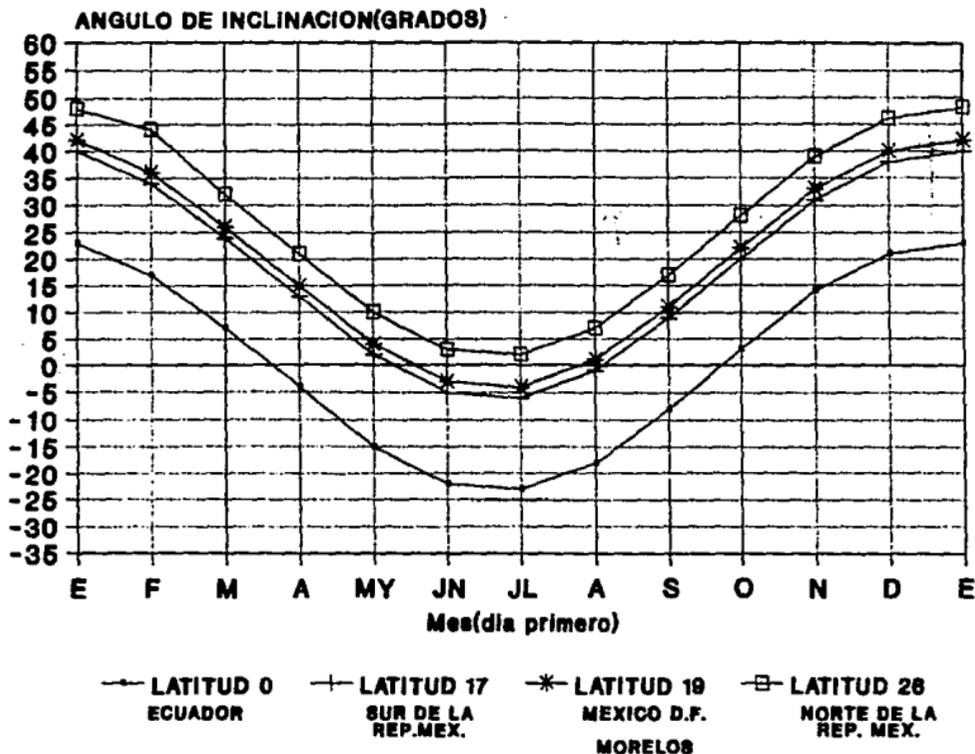
**FIG. 2.9 SEPARACION ENTRE PANELES PARA EVITAR SOMBRAS**
