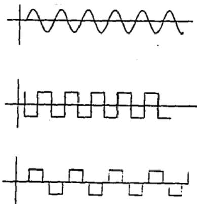
FIG. 4.26 ONDAS DE CORRIENTE ALTERNA PRODUCIDAS POR LOS DISTINTOS TIPOS DE CONVERTIDORES. LA DE LA GRAFICA SUPERIOR CORRESPONDE A UNA SINUSOIDAL PURA, LA DE ENMEDIO ES UNA TIPICA ONDA CUADRADA Y LA INFERIOR UNA ONDA CUADRADA MODIFICADA PARA QUE SE PAREZCA ALGO MAS A UNA SINUSOIDAL.
