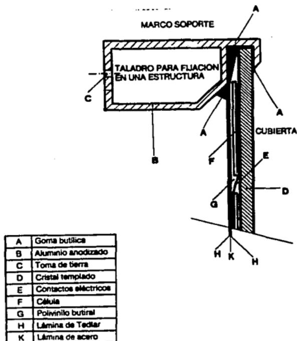
FIG. 4.16 SECCION DE UN PANEL FOTOVOLTAICO
