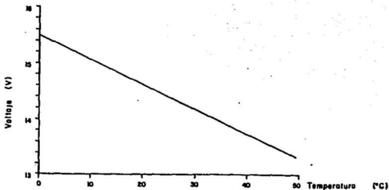
FIG. 4.23 VOLTAJE QUE HAY QUE APLICAR PARA CONSEGUIR UNA PLENA CARGA DE LA BATERIA EN FUNCION DE LA TEMPERATURA
