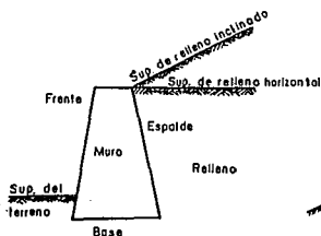
NOMENCLATURA DE UN MURO DE CONTENCION
