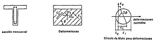
Fig. 7.5 Deformaciones del concreto a media altura del peralte (Ref. 18)
