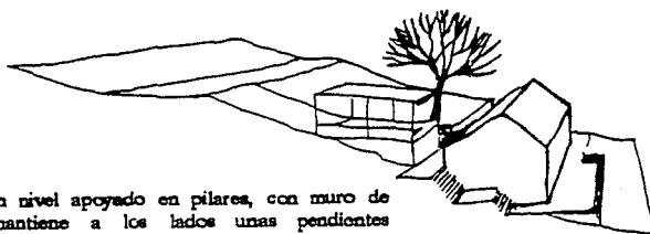
Fig. 7.1c. Casa con cimentación convencional, requiriendo de un desmonte y terraplenado considerable, los cuales se acusan a ambos lados del terreno.
