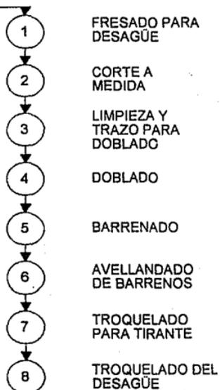
Posteriormente, pasa al corte a medida despuntando una pequeña porción de uno de los extremos del perfil y llevando éste a un tope para tener el corte a medida, ambos con un corte a escuadra de 90 grados. Estas dos operaciones, las realiza el mismo operario.
