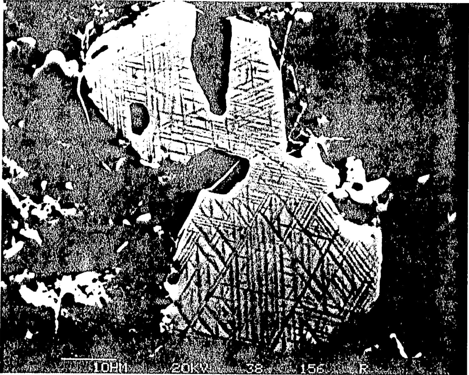
Fig. 9 Textura de Oxidacion-Exsolucion, Tipo Trellis (enrejado), fotografia tomada con el microscopio electronico (SEM).
