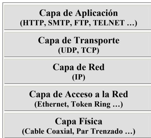
Figura 1.2. *Modelo de Capas de TCP/IP*
