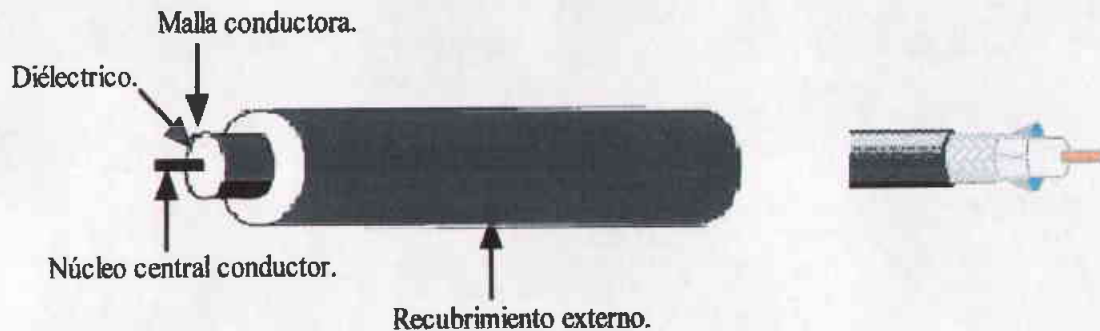
Fig. 14. Estructura de cable coaxial.
