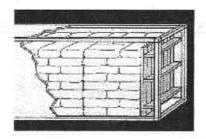
Figura 2.31 Trinca de Bultos.
