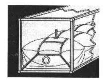
Figura 2.34 Trinca de Líquidos a Granel.
