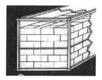
Figura 2.29. Trinca de Productos Homogéneos.
