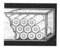
Figura 2.33 Trinca de Rollos.
