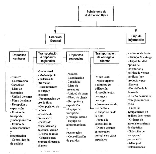
Figura 1.15 Decisiones e Informaciones para definición de Procedimientos Operativos en el Subsistema de Distribución Física. (Fuente: documento técnico no 14, SCT y IMT. Logística visión sistemática, Pág. 69).
