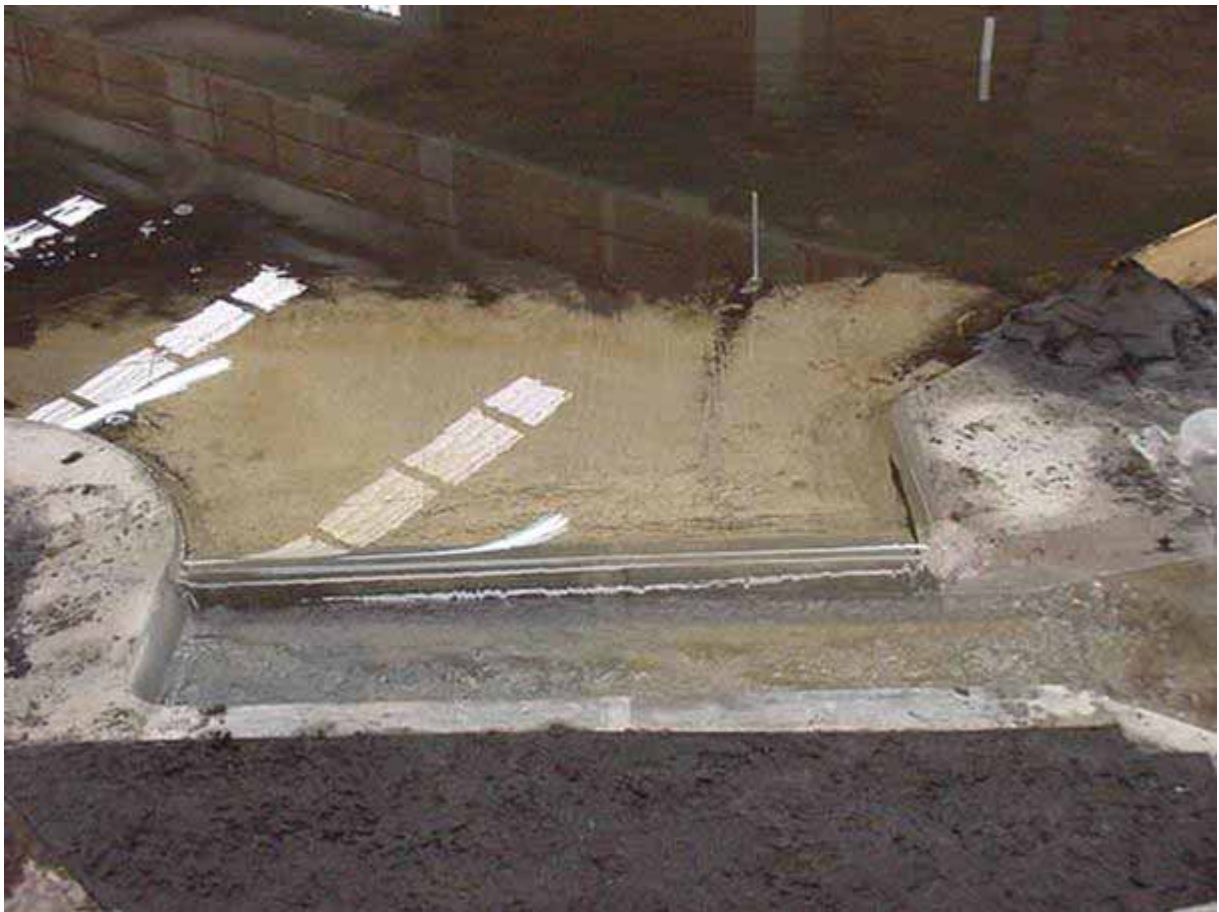
Fig.4.16 vertedor de canal lateral ( Q = 80 \text{ m}^3/\text{s} )
