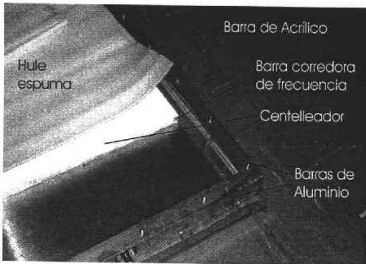
Figura 5.4 Estructura de aluminio y principales componentes del detector de centelleo.
