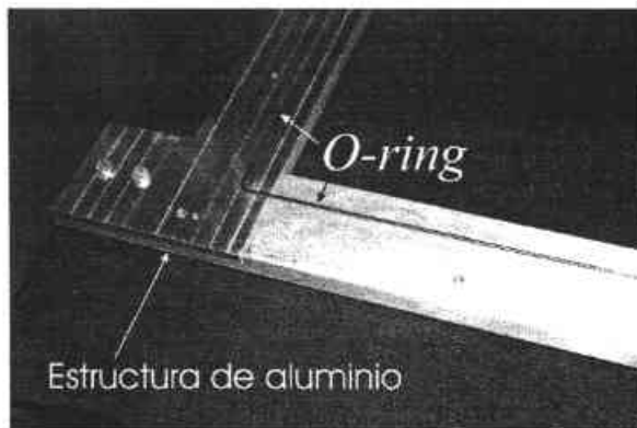
Figura 5.20 Sello cilíndrico de goma ( O-ring ) utilizado en la estructura de aluminio.
