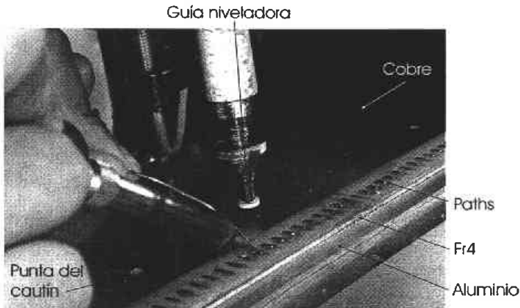
Figura 5.27 Proceso de alambrado del detector, donde aparecen los elementos involucrados.
